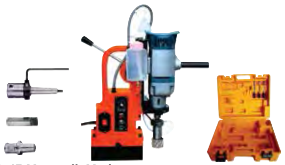
MD 45 Manyetik Matkap 720.- $ 1200 watt, 220~240 V, 50 Hz, weldon bağlantı, 45mm delme kapasitesi, 50mm delme derinliği, 100-500 dev/dak, 12000 N tork, 180 mm hareket boyu, MT2 Weldon bağlantı, MT2 mors konik, pin, hareketli tabla, 22 kg, plastik kutuda. Koli Adedi : 1
