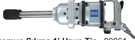
Havalı Somun Sıkma 1' Uzun Tip 09061 338.- $ 4000 d/dak,1898 Nm, 282 lit/dak,600 mm, 19 kg, 1/2 Hava giriş, Koli Adedi: 1
