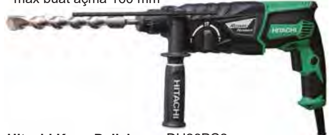
Hitachi Kırıcı Delici DH26PC2 260.00 $ 830 W, 0-1100 dev/dk, 0-4300 dar/dak, 3.2 J darbe gücü, SDS Plus uç, 3.6-26 mm beton, 32 mm ahşap, 13mm çelik delme
