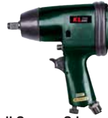
1/2" Havalı Darbeli Somun Sıkma KLHA 403 35.00 $ 340 Nm, 205 mm uzunluk, 7000 d/dak, tek çekiç, 1/4 hava giriş, 1/2 lokma, plastik kutu içinde, 2.2 kg
