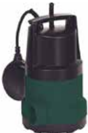
Temiz Su Dalgıç Pompa KLP550TE 55.00 $ 550 W, 10.75 Hp, 10.000 lt/saat, max basınç 0.85 bar, max yükseklik 85 mt
