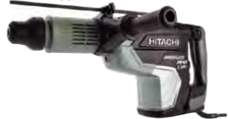
Hitachi Kırıcı Delici DH52MA 1500 W, 10-280 dev/dk, 1000-2400 dar/dak, 22 J darbe gücü, SDS Max uç, delme çapı 52 mm, max buat açma 160 mm
