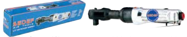
Havalı Cırcır 1/2 09351 36.40 $ 160 d/dak,69 Nm, 113 Lit/dak, 1/4 Hava giriş, 1.2 kg
