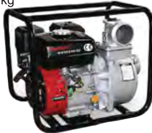
Benzinli Su Motoru 3" 250.- $ 6.5 HP, 60m 3 /saat kapasite, 15 ton/saat - 24 metre kapasite dikey arazide, 30 ton/saat - 250 metre yatay arazi, 7m max su çekme yüksekliği, 24 kg
